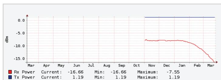
Slika 4: Na prvom dijagramu se vidi degradacija kvaliteta optičkih filtera tokom vremena. Nivo signala na prijemnoj strani prikazan je crvenom bojom. Na drugom dijagramu se vidi slabljenje izazvano lošim materijalom
